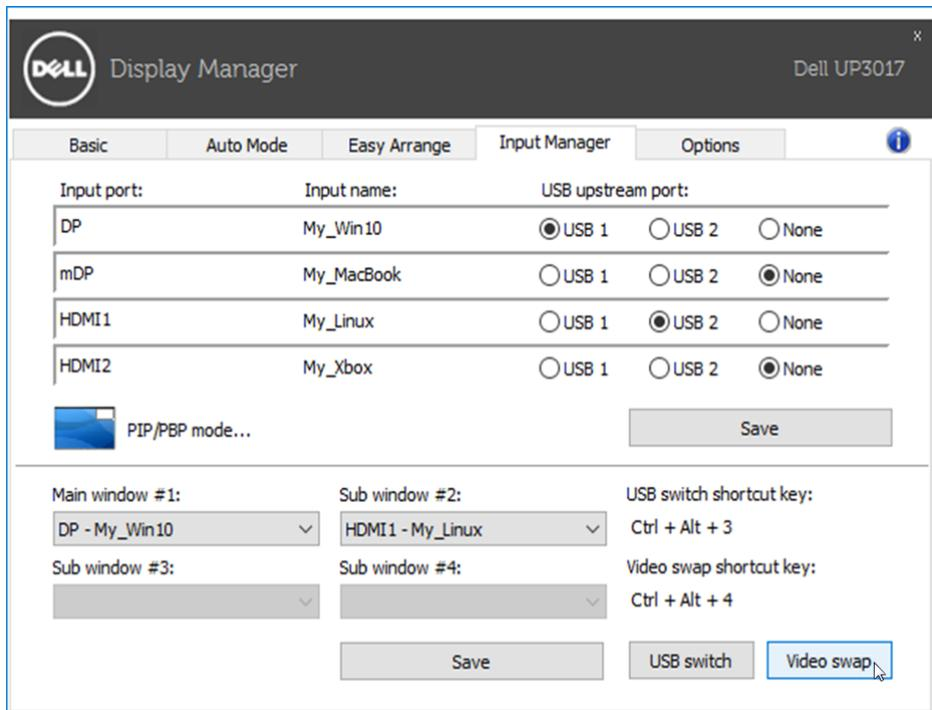
ניתן להקצות חיבור USB לחיבור למחשב עבור כניסת הווידאו. חיבור ה-USB שהוקצה לחיבור למחשב יחובר למחשב כשהווידאו שלו מוצג בצג. הדבר מועיל במיוחד אם אתה משתף עכבר או מקלדת המחברים לצג בין שני מחשבים. ניתן להגדיר מקש קיצור להעברה מהירה של ההתקן בין שני מחשבים.
